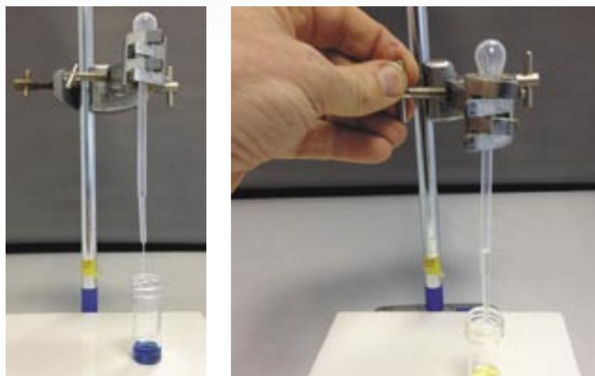
Figure 2 - Microscale titration using a Pasteur pipette.
