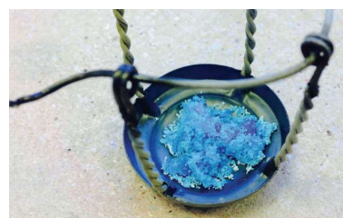
Figure 6 - A mini crucible.
